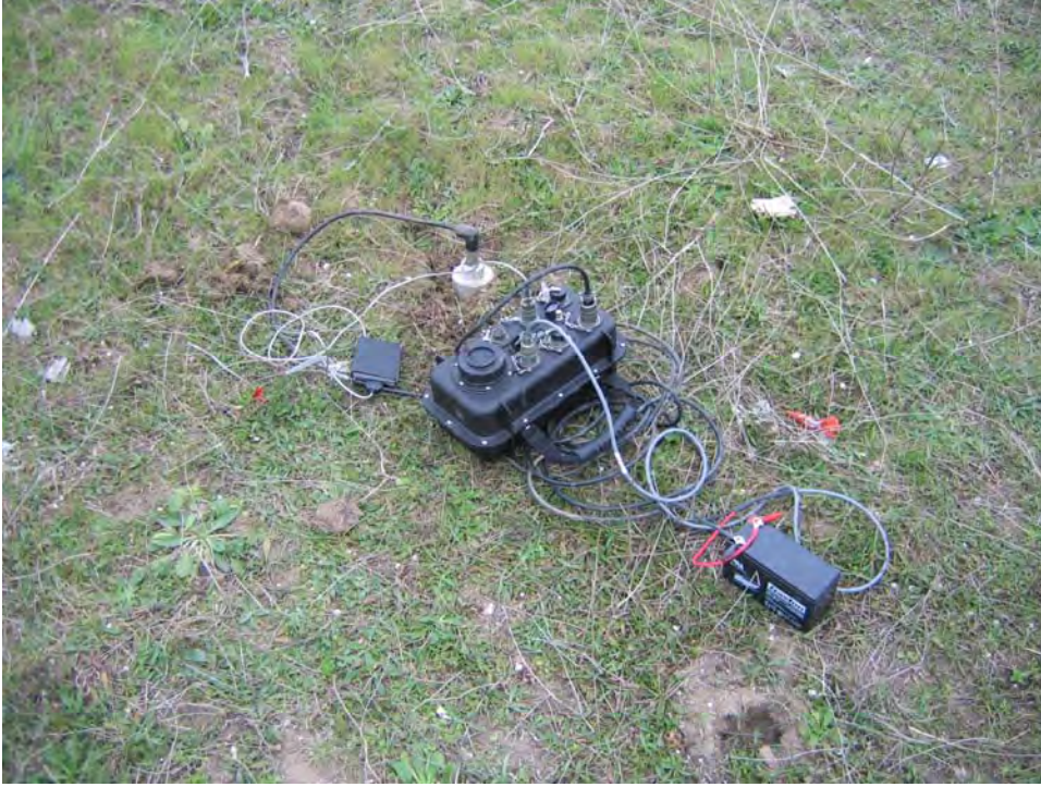
Şekil 5: Bir dizilim noktasında kullanılan kayıtçı sistem ve sismometre.
