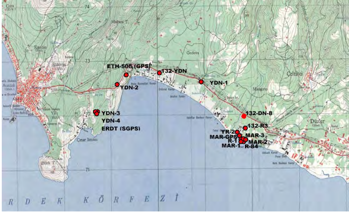
Şekil-4.1: Erdek mareograf istasyonu yerel nivelman ağı noktaları (mareograf istasyonu röper noktaları ile ERDE SGPS noktasını içermektedir).
