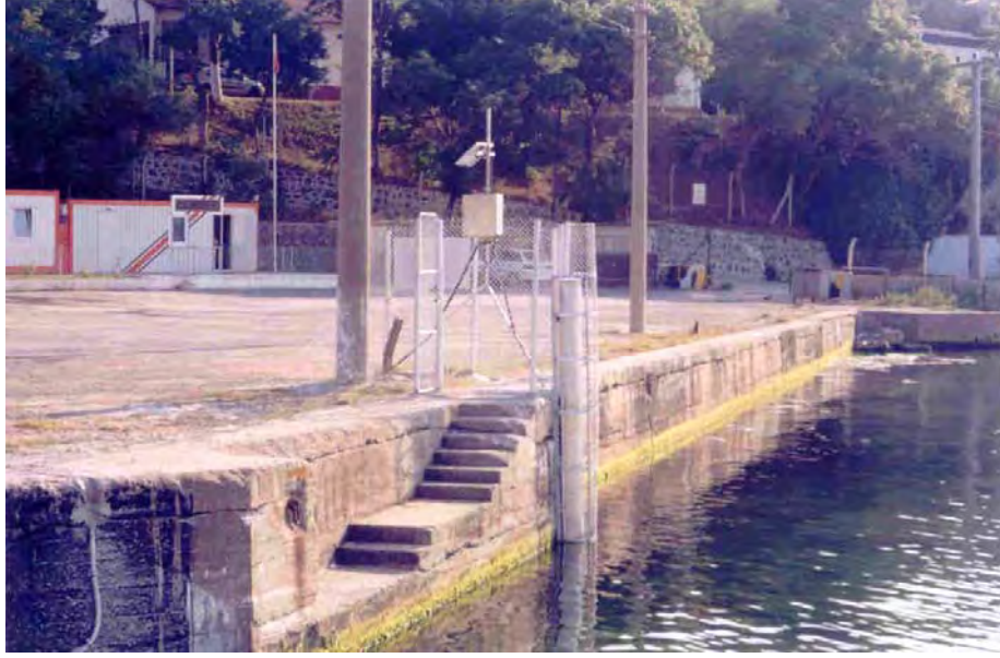
Şekil-2.3: Marmara Ereğlisi Mareograf İstasyonu
