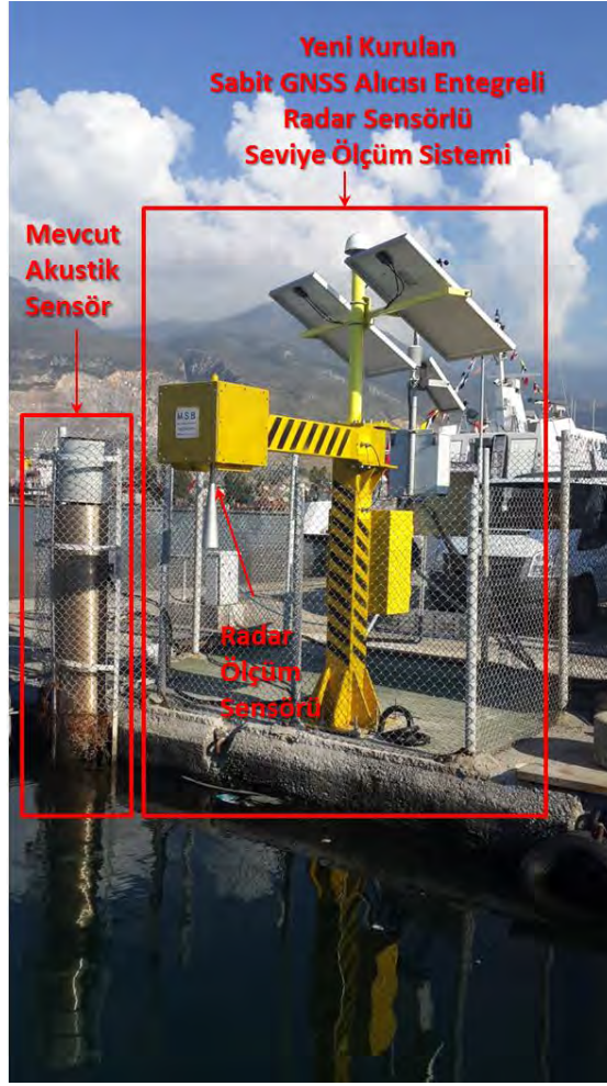
Şekil 15. İskenderun mareograf istasyonuna kurulan sabit GNSS alıcısı entegreli radar deniz seviyesi ölçer istasyonu.
