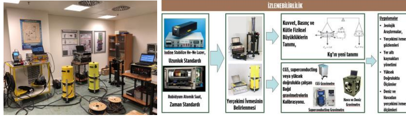
Şekil 1. Mutlak yerçekimi ölçerler ve yerçekimi ivmesi ölçümlerinde izlenebilirlik zinciri
