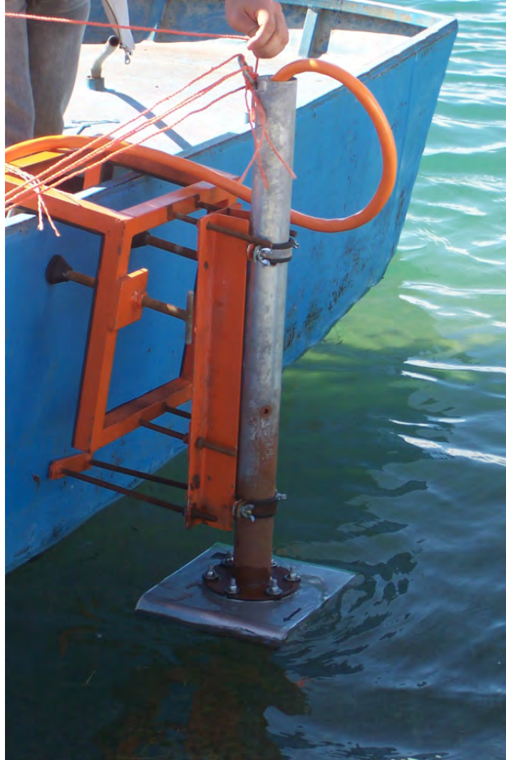
Şekil 42. Tekne kenarına askı ile monte edilmiş sismik transducer cihazı. Turuncu renkli kablo güç ve veri kablosudur. Transducer tablası askı borusuna sismik izolator vazifesi gören lastik contalar ile sabitlenmiştir.
