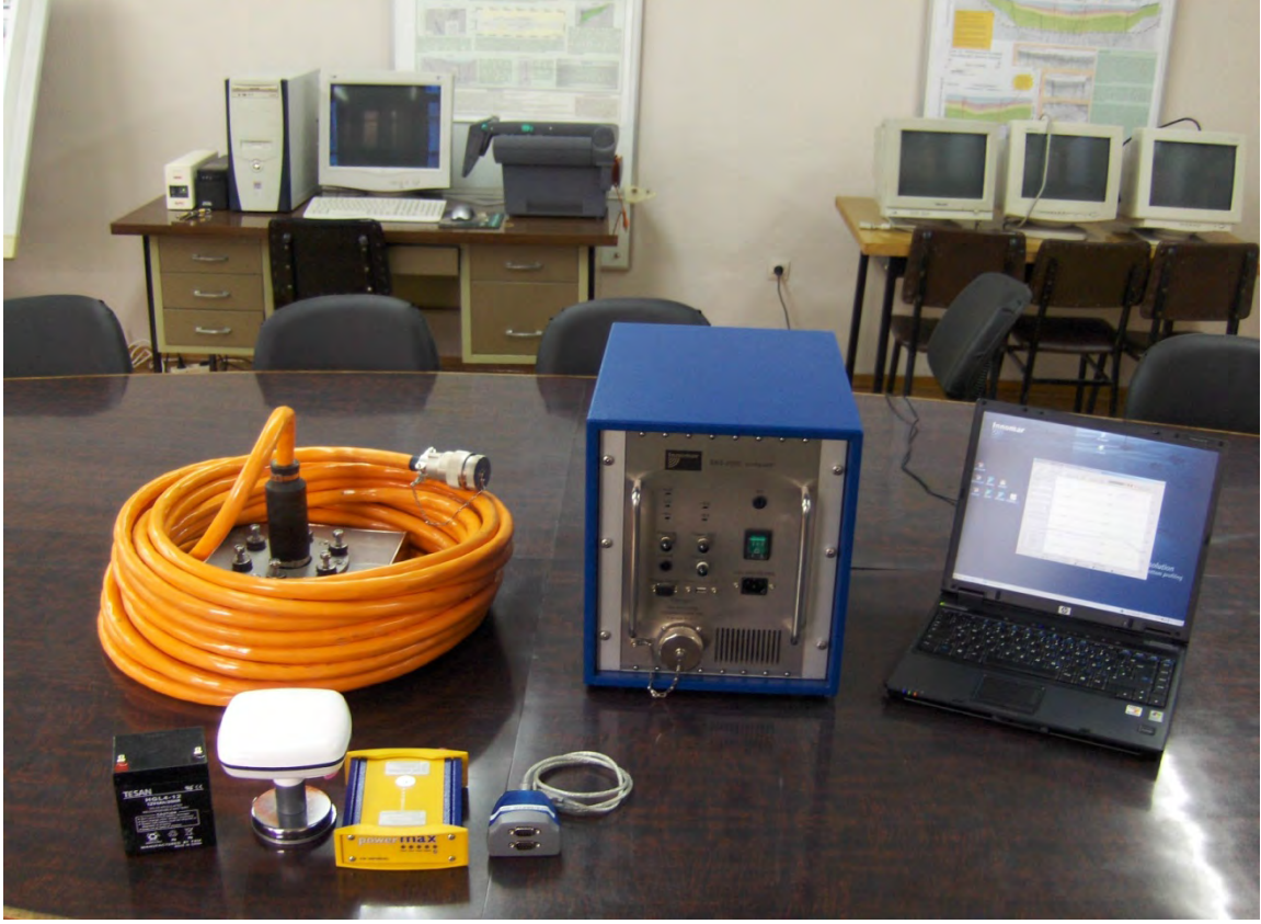
Şekil 40. Çalışmada kullanılan cihazlar (arkada soldan sağa: sismik transducer, sismik enerji ünitesi, control sistemi; önde: mobil navigasyon sistemi).
